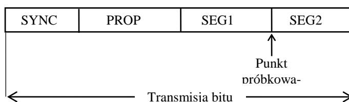
Rys. 4. Fazy transmisji pojedynczego bitu
