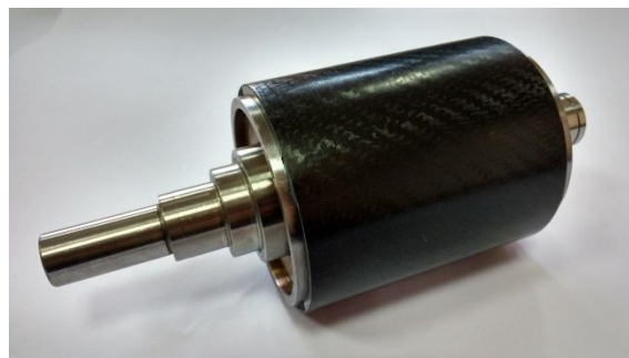
Rys. 2. Przykład zabezpieczenia magnesów trwałych w wirniku typu SPM, przez pierścień kompozytowy z warstwami wzmocnionymi włóknem węglowym CFRP
