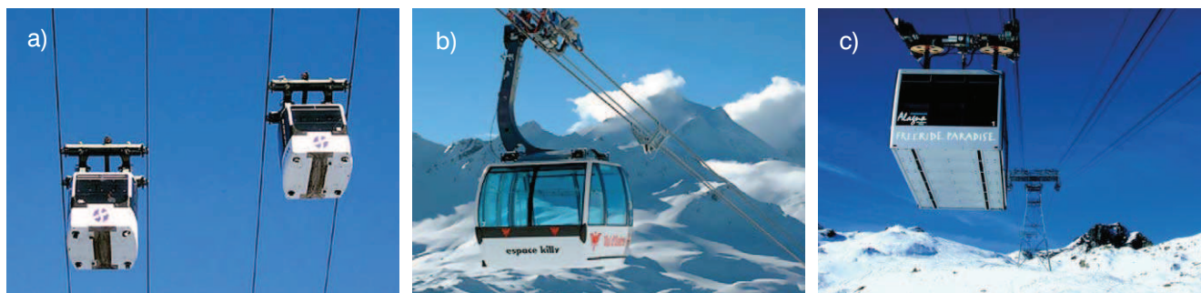
Rys. 9. Systemy kolei linowych: a) „Funitel” w Val Thorens, Francja [7], b) „L'Olympique” w Val d'Isère, Francja [8], c) „Funifor” w Alagna, Włochy [8]
