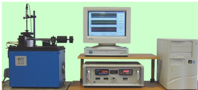
Rys. 1. Stanowisko tribologiczne – tester T-11 [9]
