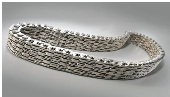
Rys. 11. Łańcuch przekładni CVT [23]
