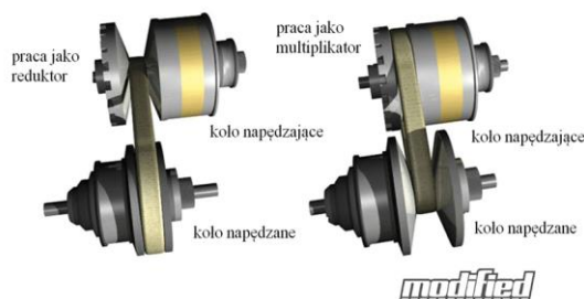
Rys. 9. Zasada pracy przekładni CVT z pasem pchanym[21].
