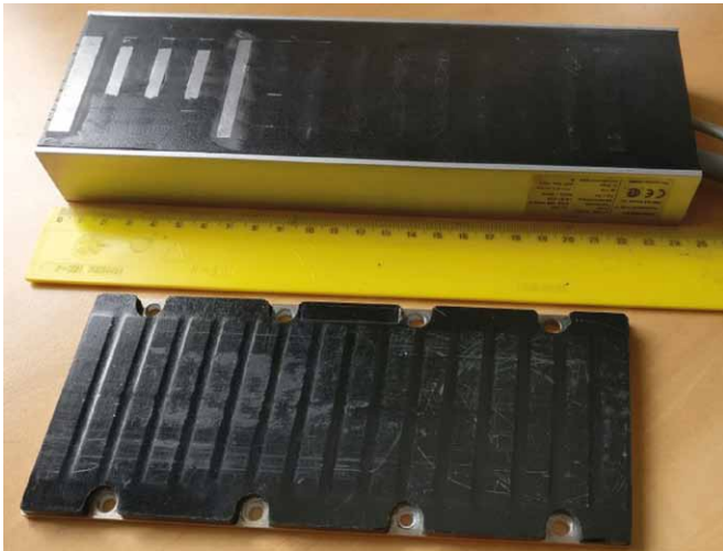
Rys. 1. Przykład silnika CW-FLPMSM, u góry widoczny biegnik z częściowo odsloniętymi zębami rdzenia, na dole bieźnia magnetyczna z magnesami trwałymi
