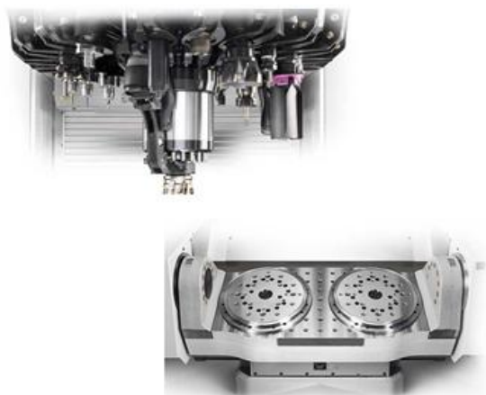
Rys. 1. Przykłady rozwiązań wykorzystywanych w konstrukcji obrabiarek CNC do wysokowydajnej obróbki skrawaniem [1]: a) magazyn kosztowy do szybkiej zmiany narzędzi, b) stół uchylny-obrotowy do wieloprzedmiotowej obróbki
