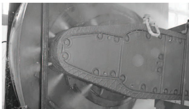
Rys.8. Zraszanie powietrzno-wodne kombajnu KSW-800NE [5]
