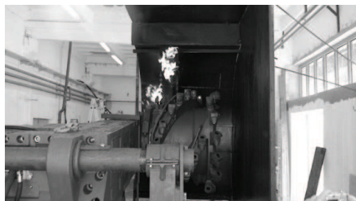
Rys. 11. Próba gaszenia zapłonu gazu [9]
