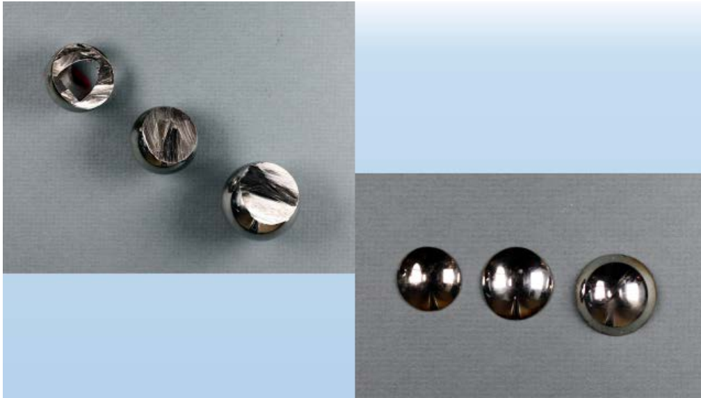
Fot. 14. Fragmenty odciętych główek endoprotez. Fot. lewa – widok od strony endoprotezy. Fot. prawa - widok od strony stawu.
