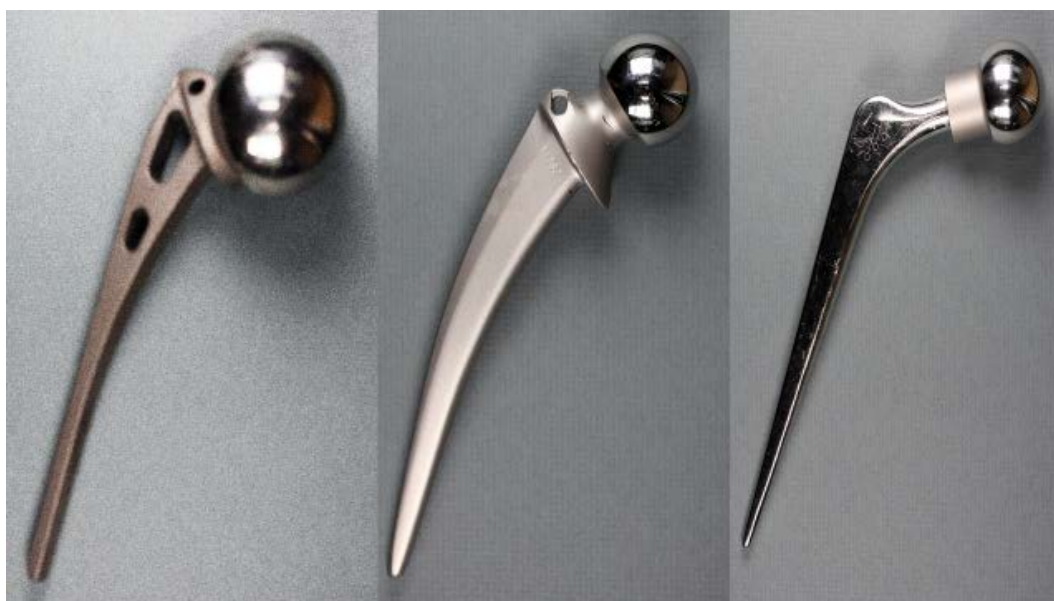
Fot. 13 Oczyszczone , metalowe części endoprotez poddane badaniom, które usunięto pacjentom podczas wymiany endoprotezy .
