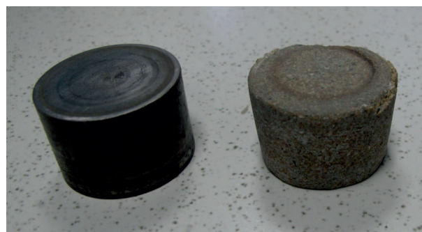
Fot. 4. Próbki wykorzystane podczas badań: stal i piaskowiec
