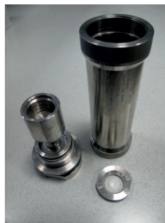
Fot. 3. Uchwyt na próbkę i komora
