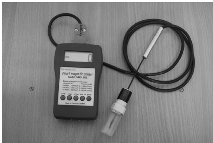
Rys. 2. Miernik hallotronowy SMS102 wraz z sondą pomiarową Fig. 2. Hall Effect Meter SMS102, together with the measuring probe
