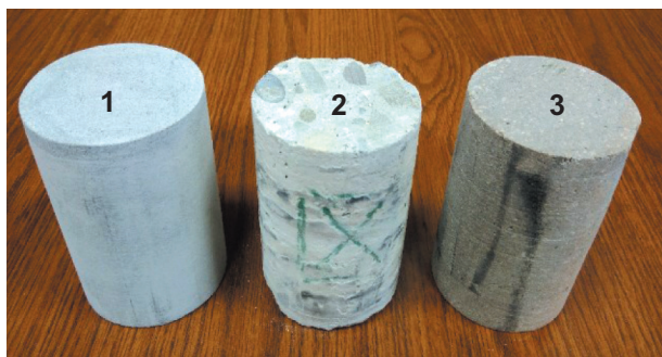
Rys. 3. Widok próbek przygotowanych do badań: 1 – piaskowiec, 2 – beton, 3 – porfir
