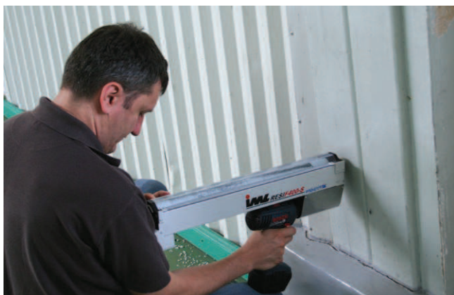
Rys. 7. Pomiar z użyciem rezystografu
