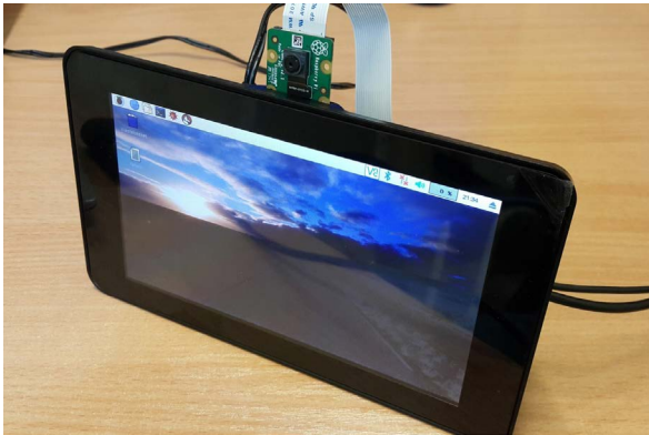
Rysunek 2. Fotografia systemu wizyjnego, w którym wykorzystano dotykowy wyświetlacz TFT
