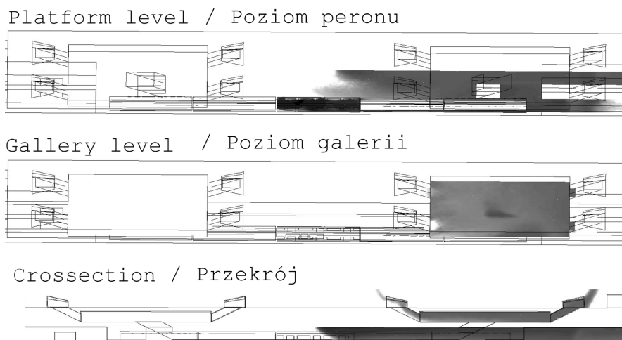
Ryc. 8. Wpływ dymu na galerię stacji w scenariuszu 4 (25 MW) Fig. 8. Smoke penetration across the station passageways in scenario 4 at 25 MW Źródło: Opracowanie własne. Source: Own elaboration.
