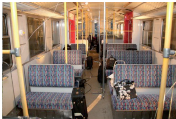
Ryc. 2. Wagon metra typu X1 wykorzystany w badaniach oraz rozmieszczenie bagaży wewnątrz wagonu [20]
