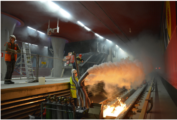
Ryc. 10. Zadymienie ¼ obszaru stacji obserwowane w przypadku prób z gorącym dymem oraz w analizie numerycznej dla małej mocy pożaru Fig. 10. 25% of station area filled with smoke, observed during hot smoke tests and numerical analysis of small fire intensity
