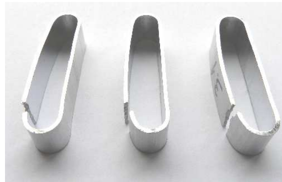
Rys. 7. Zestawienie maksymalnego naprężenia R_m w próbkach poprzecznych oraz przykładowe pęknięte pierścienie po rozciąganiu
