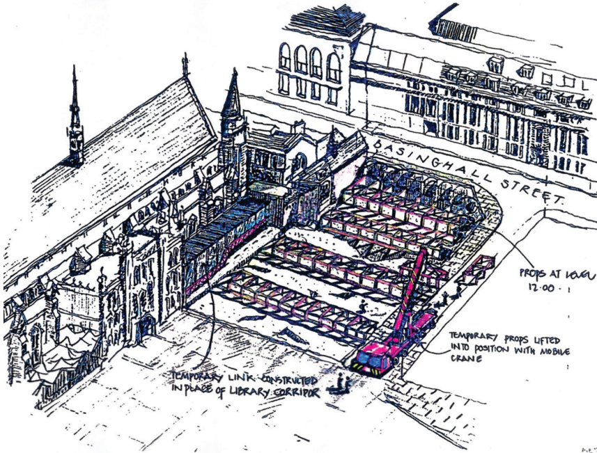
Rys. 3. Koncepcja rozporu wykopu w Guildhall Yard East [7]
