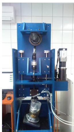
Rys. 19. Symulator ruchu stawu biodrowego SBT-01.02, schemat ogólny
