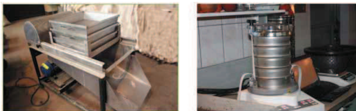
Rys. 4. Badania laboratoryjne zmian uziarnienia materiałów zasypowych
