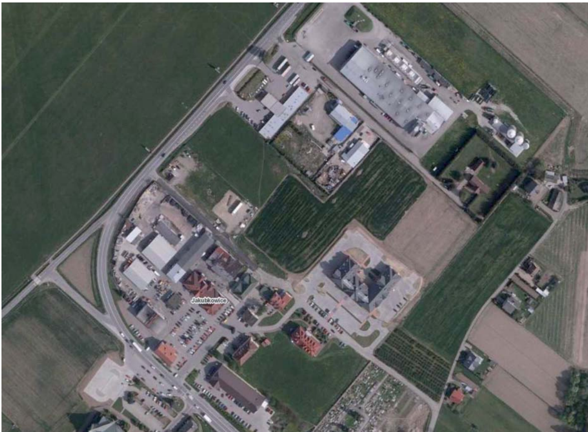
Fot. 2. Odcinek drogi krajowej ze zjazdem do marketu (bez pasa wyłączania i włączania) i z przejściem umieszczonym na łuku o złej widoczności
