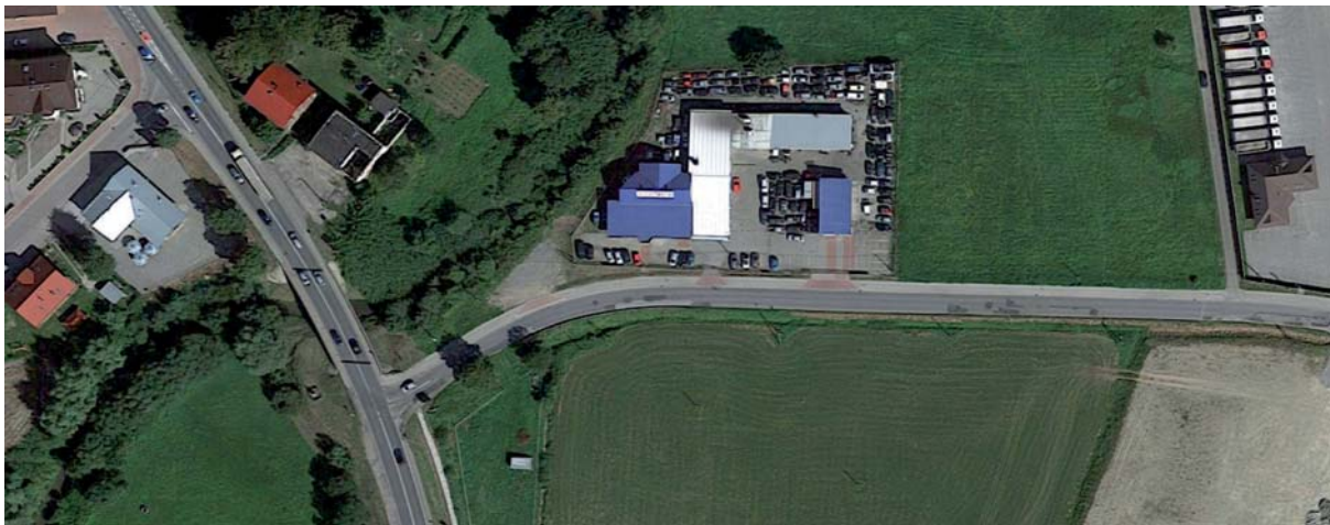
Fot. 5. Wjazd z zakładów przemysłowych na drogę GP pośrednio przez drogę powiatową lub gminną na skrzyżowanie (zlokalizowane na moście) także bez pasów włączania/wyłączenia na drodze GP
