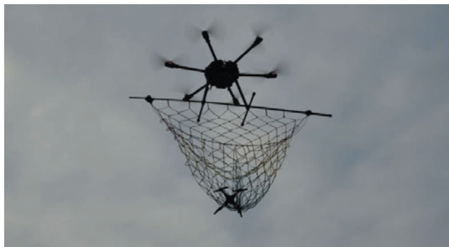
Rycina 7. Przykład pojazdu bezzałogowego, który przechwycił niechcianego drona [26]
