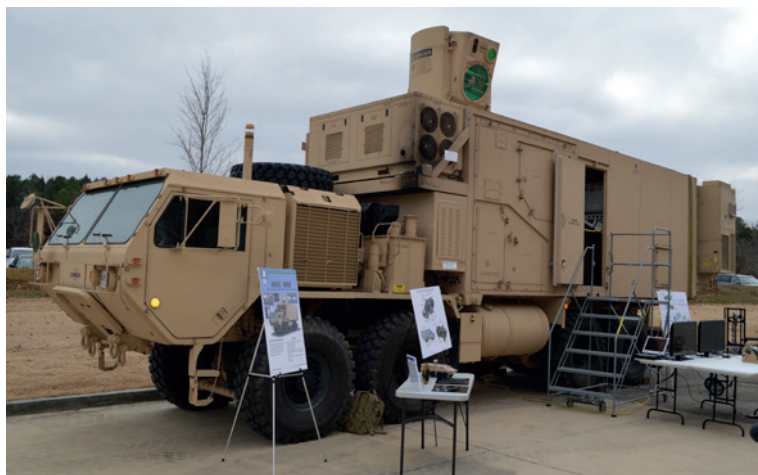
Rycina 5. Przykład systemu laserowego wykrywania i niszczenia pojazdów bezzałogowych, zainstalowany na dachu wozu opancerzonego [24] Figure 5. An example of a laser detection and destruction system for unmanned vehicles, which is installed on the roof of an armoured vehicle [24]
