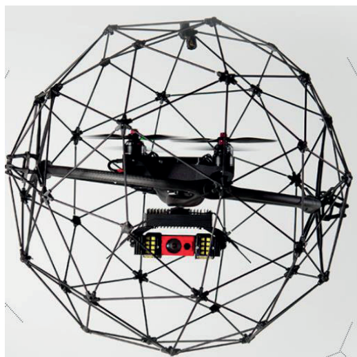
Rycina 1. Wielowirnikowiec wyposażony w klatkę osłaniającą cały pojazd przed bezpośrednim dostępem do elementów wirujących (po lewej stronie) [11] oraz indywidualne zabezpieczenie każdego z wirników (po prawej stronie) [12]
