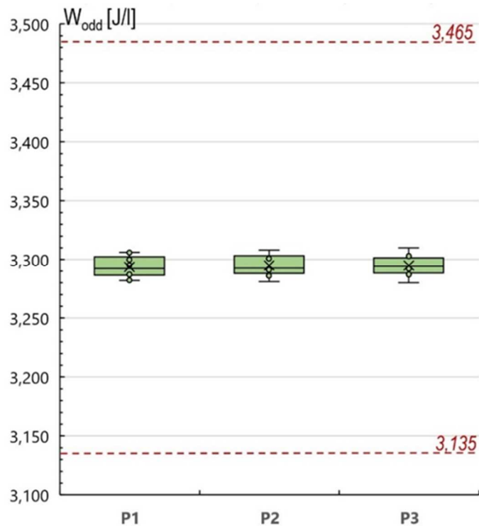
Rys. 15 Graficzne przedstawienie wyników sprawdzenia układu pomiarowego symulatora oddychania za pomocą dyszy kalibracyjnej.
