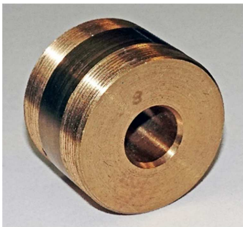
Rys. 13 Dysza kalibracyjna zgodna z normą PN-EN 250:2014 : a) wygląd dyszy; b) sposób zamontowania dyszy w stanowisku badawczym.
