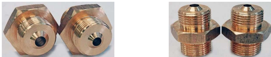
Rys. 11 Widok dodatkowo wykonanych dysz do współbieżnego zaworu redukcyjnego drugiego stopnia automatu oddechowego.
