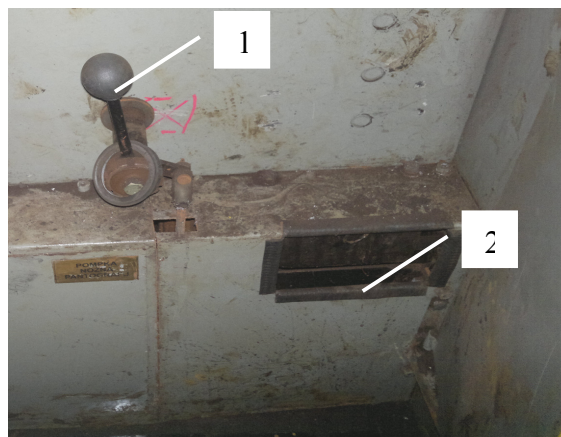
Rys. 7. Piasecznica [3] 1 – dźwignia piasecznicy, 2 - zbiornik
