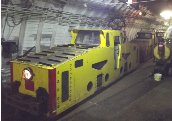
Rys. 3. Widok lokomotywy Ld-31EM połączonej z dwiema lokomotywami Ld-21 stanowiącymi obciążenie [3]
