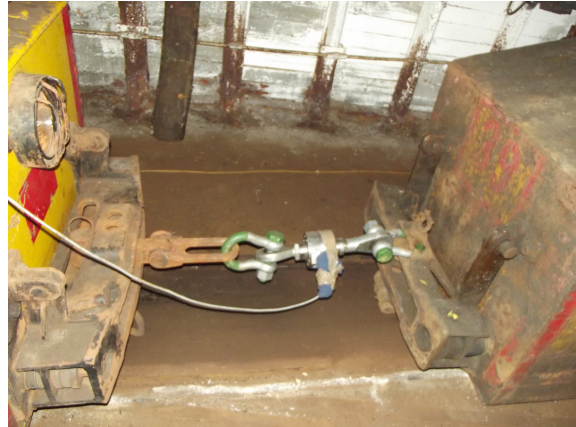
Rys. 4. Widok umiejscowienia przetwornika siły [3]
