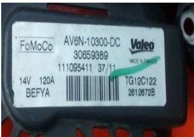
Rys. 6. Tabliczka znamionowa zawierająca parametry i oznaczenie badanego alternatora
