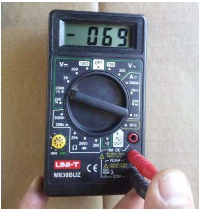
Rys. 5. Wynik pomiaru prądu w stanie dużego obciążenia, 1mv=1A
