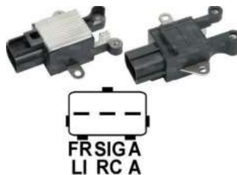
Rys. 2. Widok i opis wyprowadzeń sterownika alternatora firmy Denso
