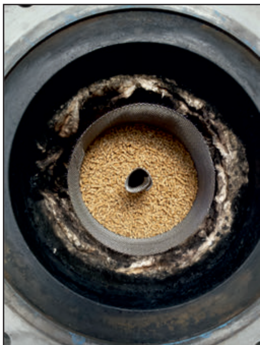
Rys. 1. Komora reakcyjna – efekt pełnej konwersji pelletu sosnowo-świerkowego Fig. 1. Reaction chamber – effect of the spruce-pine pellet's total conversion
