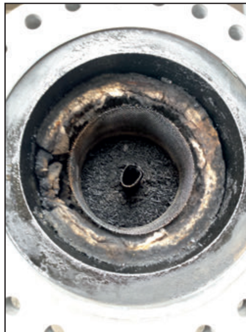
Rys. 1. Komora reakcyjna – efekt pełnej konwersji pelletu sosnowo-świerkowego Fig. 1. Reaction chamber – effect of the spruce-pine pellet's total conversion
