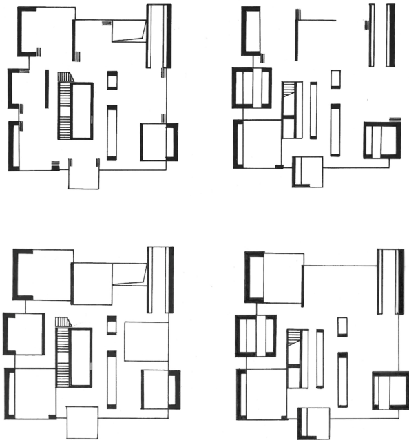
Rys. 5. Villa A, rzut parteru (z prawej) i piętra (lewej) w skrajnych aranżacjach wnętrza; źródło: rysunek autora
