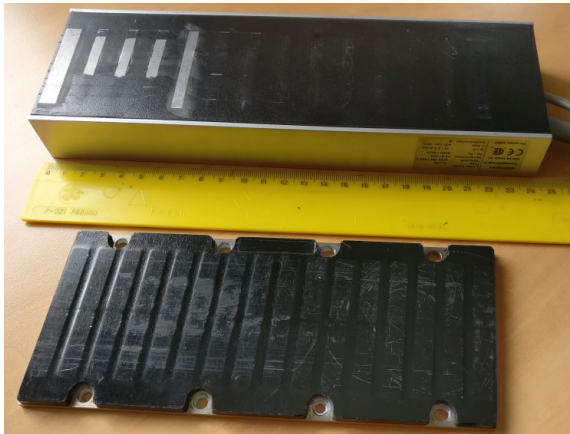
Rys. 1. Przykład silnika CW-FLPMSM, u góry widoczny biegnik z częściowo odsłoniętymi zębami rdzenia, na dole bieźnia magnetyczna z magnesami trwałymi
