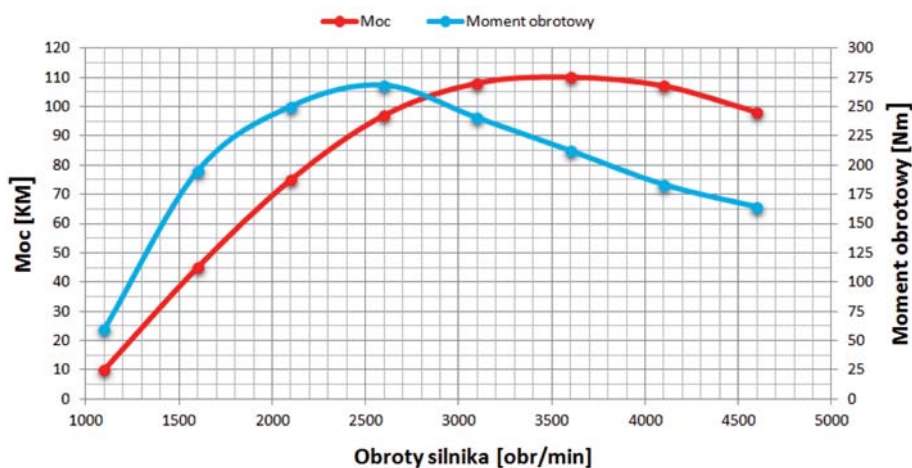
Rys. 1. Wykres zależności mocy i momentu od obrotów silnika Opel Astra 1,9 CDTI 100 KM
