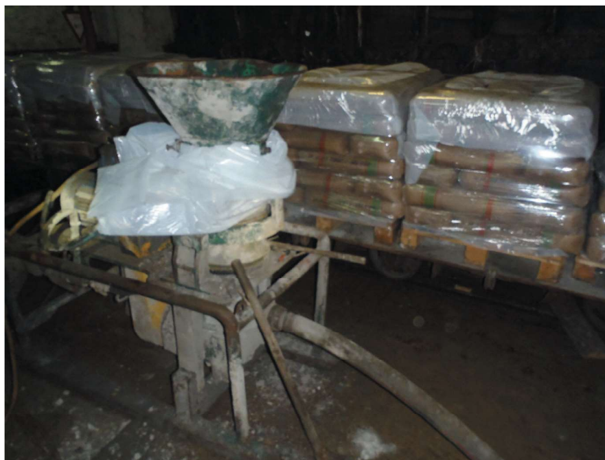
Rys. 3. Torkretnica wraz z spoiwem do torkretowania (materiał własny)
