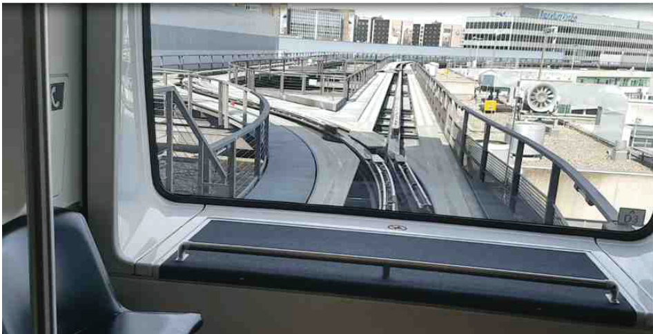
Rys. 4. System lotniskowego transportu pasażerów na lotnisku w Pekinie jako przykład systemu transportu po predefiniowanych drogach przebiegu
