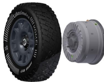
Rys. 2. Koncepcja zabudowy zintegrowanego napędu do użytkowych pojazdów elektrycznych
