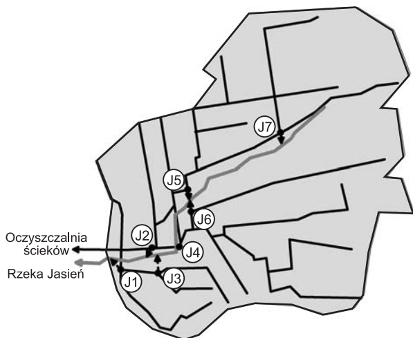
Rys. 1. Schemat systemu kanalizacji ogólnospławnej w badanej zlewni
