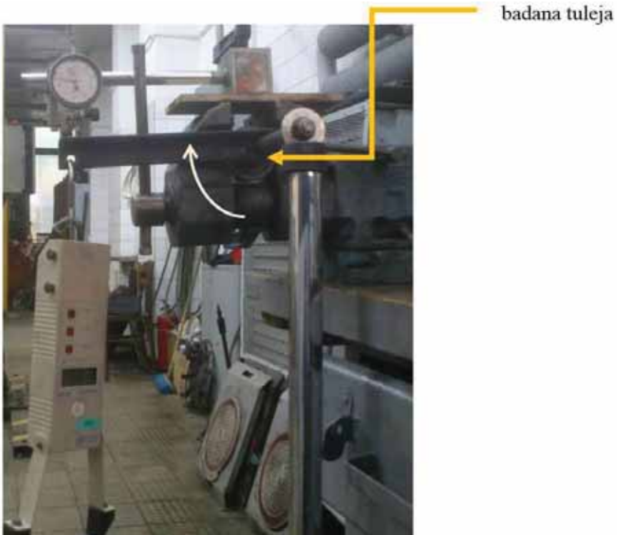
Fot. 3. Wyznaczanie sztywności kątowej przegubu na skręcanie
