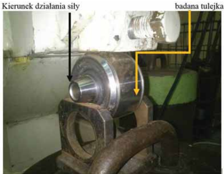
Fot. 2. Wyznaczanie sztywności promieniowej przegubu
