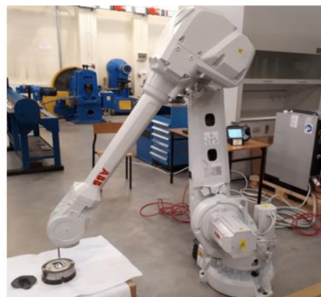
Rys.8. a) Idea działania systemu smarowania wraz z przykładowym schematem cyklu pracy, b) wykorzystanie ramienia manipulatora do ukierunkowanego podawania środka smarno-chłodzącego
