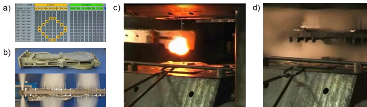
Rys. 6. Widok: a) panelu z systemu smarowania z układem aktywnych (wybranych dysz) firmy Jerko [19], b) widok płyty smarującej z dyszami, c) manipulator z chwytakiem wkładający przedkuvkę, d) wjazd płyty smarującej i uruchomienie smarowania
