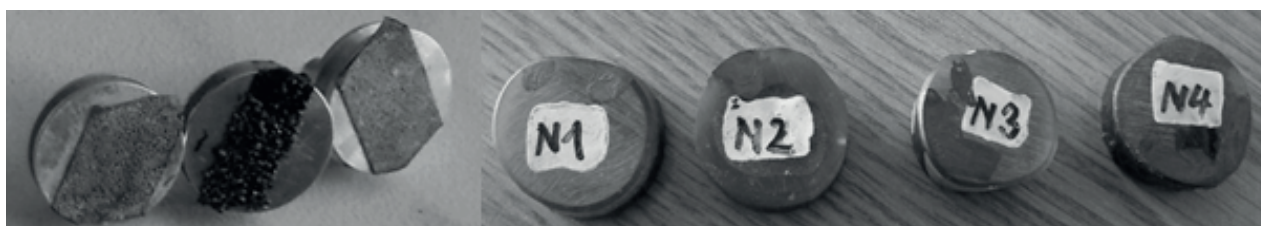
Fig. 3. left) samples of abrasive on carbon ribbon; right) abrasive embedded into resin (polished sections) Rys. 3. Lewa) próbka materiału ściernego na taśmie węglowej; prawa) materiał ścierny w żywicy (szlif)
