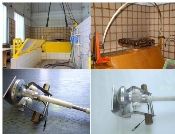
Rys. 6. Urządzenia probiercze do badań IPX3 oraz IPX4
