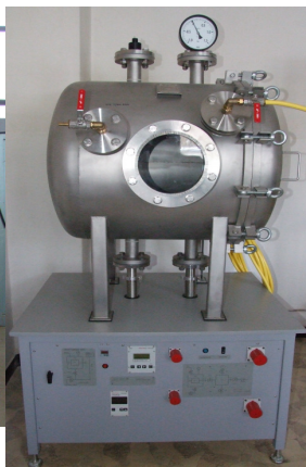
Rys. 8. Stanowisko do badania szczelności z wykorzystaniem helu
