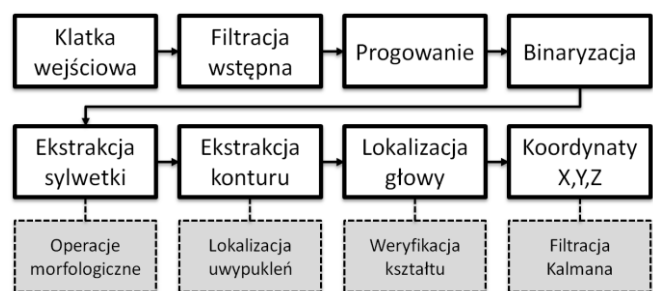
Rys. 2. Schemat funkcjonalny zaproponowanego systemu śledzenia głowy
