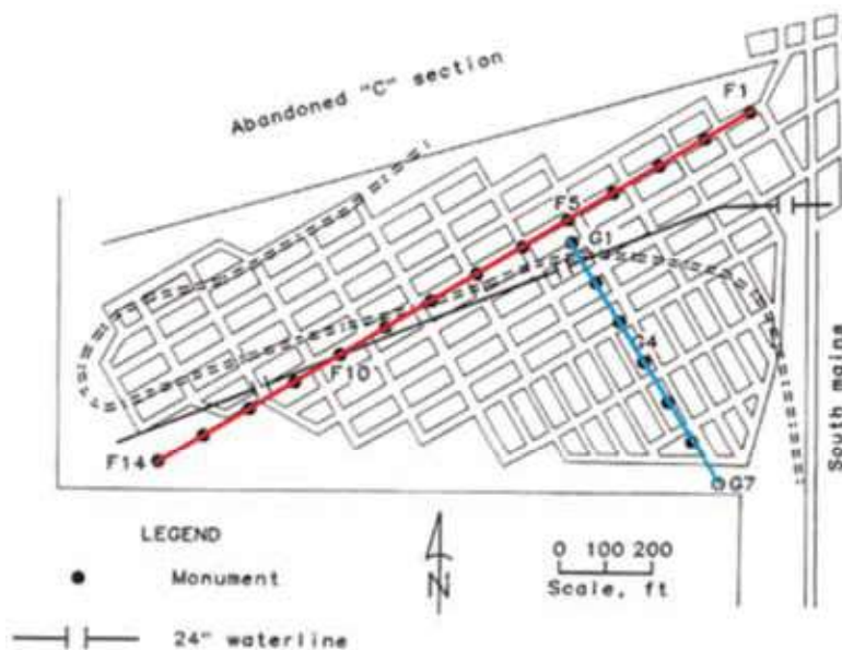
Rys. 11. Eksploatacja w polu południowo-zachodnim i lokalizacja linii pomiarowych 1-F14 i G-1-G7 (Magers 1993)
