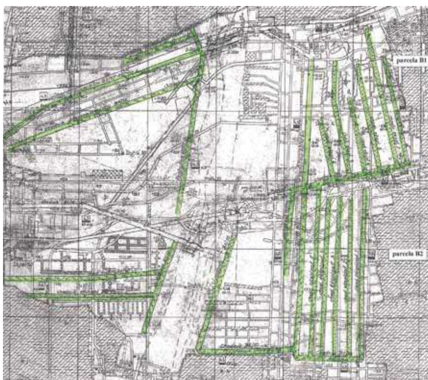
Rys. 4. Eksploatacja chodnikami w pokładzie 510 Fig. 4. Roadway panels in the coal seam no. 510
