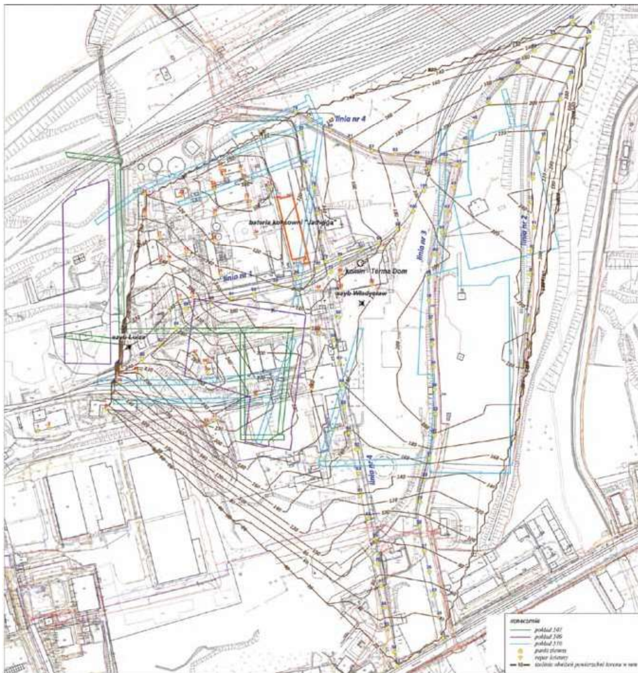
Rys. 5. Izoliny obniżeń spowodowane eksploatacją parcel w pokładach 507, 509 i 510
