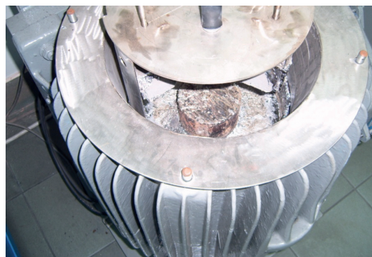
Rys. 14 Urządzenie z pokrywą z zamontowanymi wkładami ceramicznymi.
