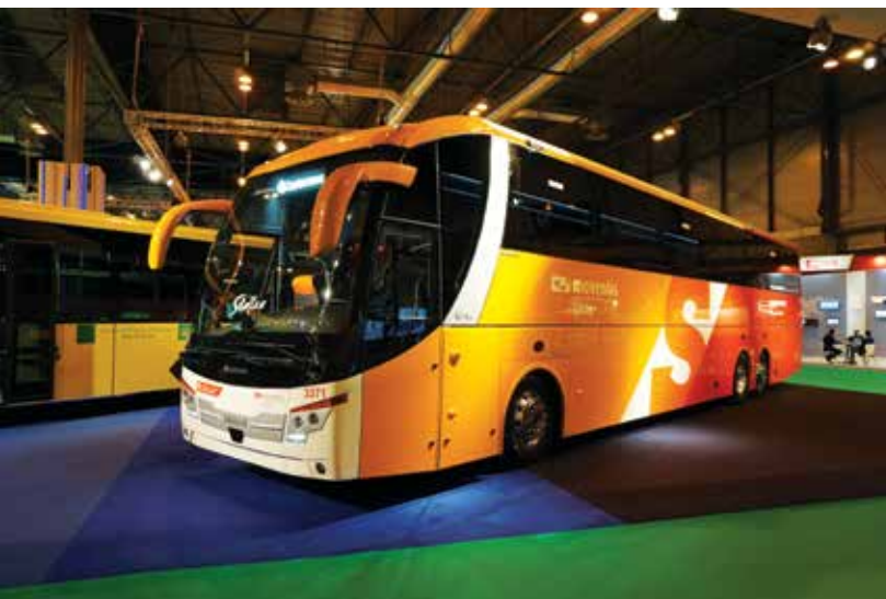
Turystyczny autokar Castrosua Stellae zbudowany na trzyosiowym podwoziu MAN RR4
