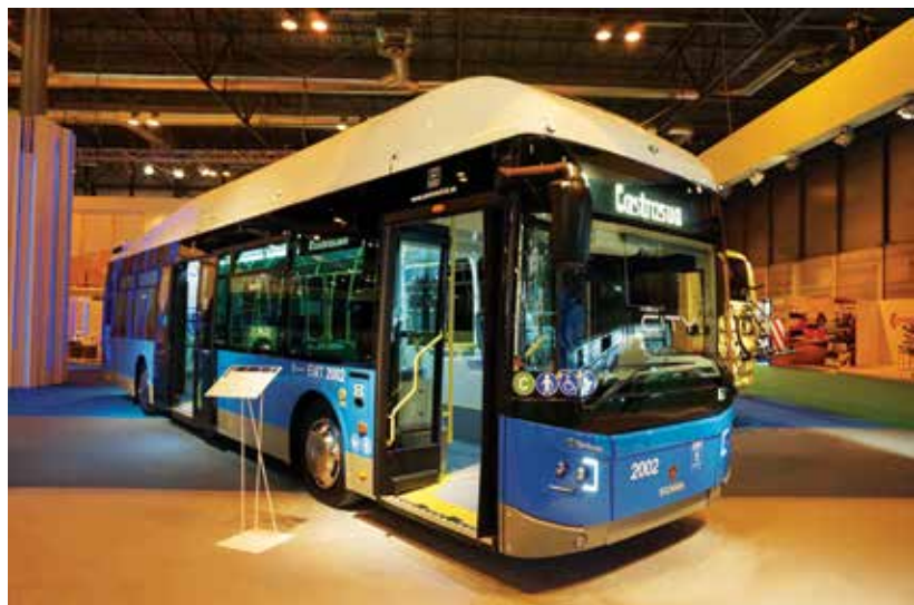
Miejski, niskopodłogowy autobus NewCity, napędzany sprężonym gazem ziemnym, przeznaczony dla stołecznego przedsiębiorstwa EMT w Madrycie
