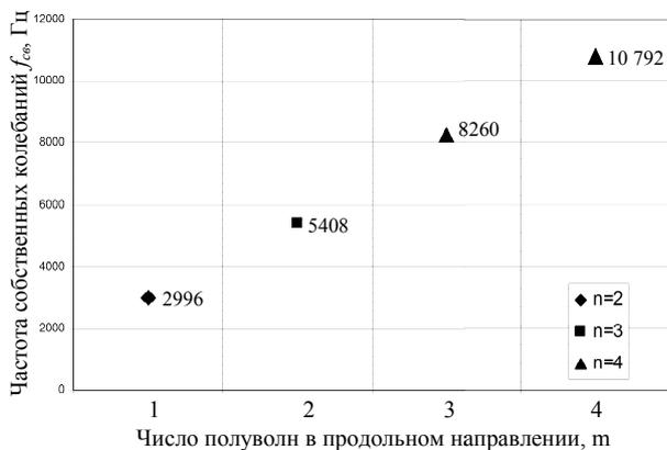
Рис. 3. Спектр частот собственных колебаний втулки 4Ч8,5/11 в случае свободной опоры верхнего бурта и жесткой заделки нижнего посадочного пояса
