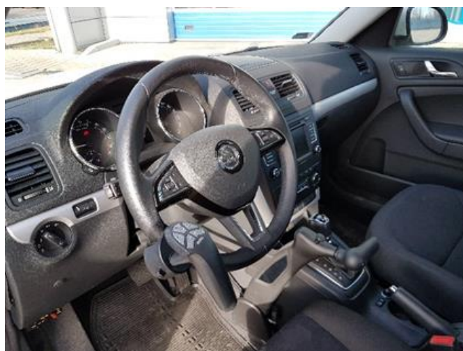
Rys 2. Oprzyrządowanie – pilot na kierownicy z możliwością szybkiego demontażu (zdjęcie ITS).
