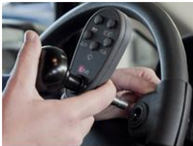
Rys 1. Oprzyrządowanie Kivi Pulpit PV3000 (Kivi transmitter), zdjęcie przedstawia szybką możliwość demontażu [13].
