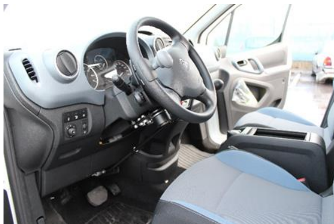
Rys 3. Oprzyrządowanie – gałka na kierownicę z systemem szybkiego demontażu o ergonomicznym kształcie poprawiającym uchwyt (zdjęcie ITS).
