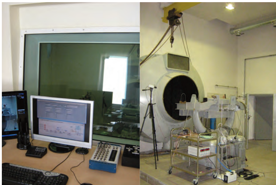
Sterownia i hamownia Laboratorium Napędów Kosmicznych, ILOT
