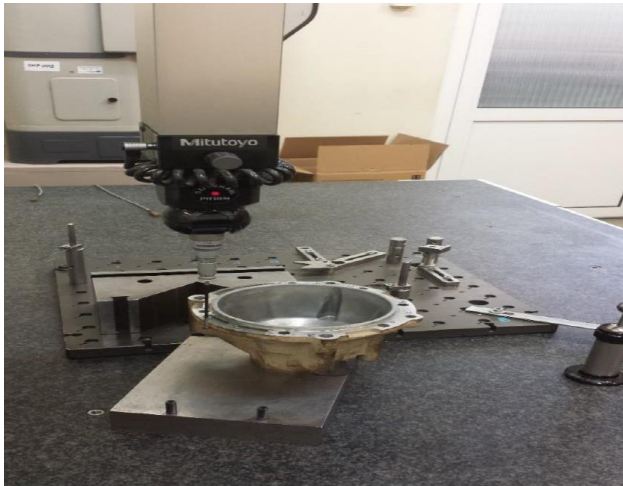
Rys. 2. Pomiar obudowy mechanizmu różnicowego przy pomocy maszyny CMM Mitutoyo Crysta Apex 1610S
