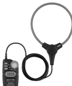
Rys. 3. Widok przykładowych cewek Rogowskiego (w elastycznych obudowach) zespolonych z integratorem i woltmierzem
