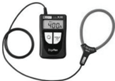
Rys. 3. Widok przykładowych cewek Rogowskiego (w elastycznych obudowach) zespolonych z integratorem i woltmierzem
