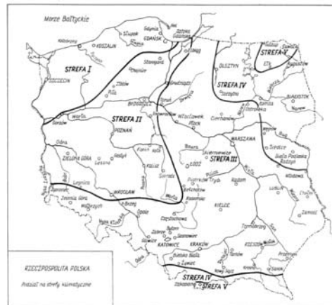
Rys. 5. Podział Polski na strefy klimatyczne wg PN-EN 12831:2004 i PN-EN 12831:2006 Fig. 5. Winter climatic zones of Poland by PN-EN 12831:2004 and PN-EN 12831:2006 standards
