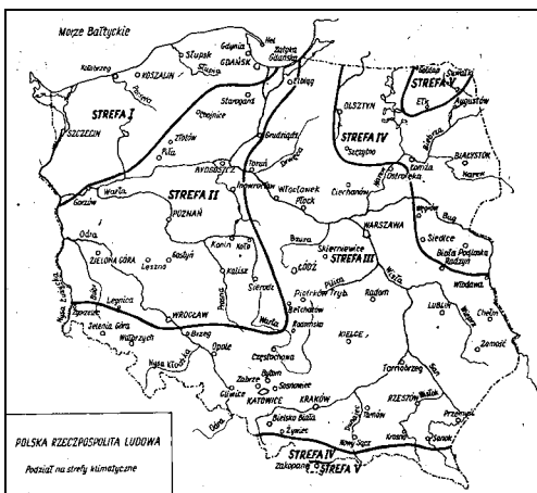
Rys. 4. Podział Polski na strefy klimatyczne wg PN-82/B-02403 Fig. 4. Winter climatic zones of Poland by PN-82/B-02403
