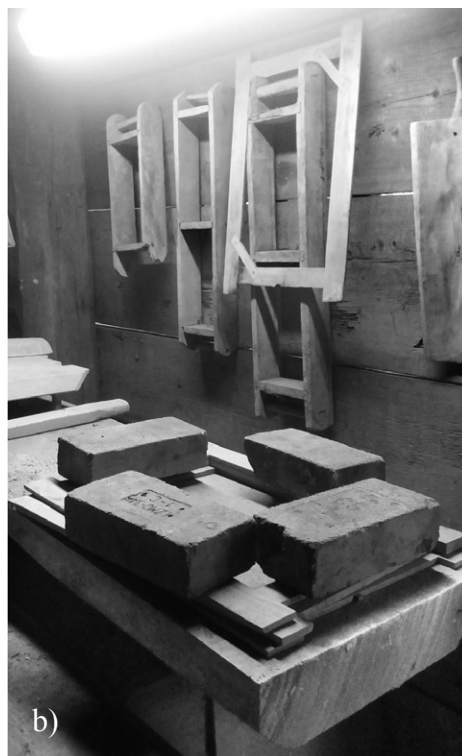
Ryc. 19 a-b. Formy do „wybijania” dachówek i cegieł w pracowni Pawła Piechowskiego; fot. J. Ciecuch i P. Gołębiowski, 2016
