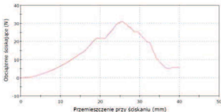
Rys. 3. Zmiany wartości siły [N] w funkcji przemieszczenia przy ściskaniu w teście przecinania metodą Warnera-Bratzlera.
