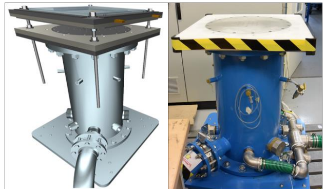
Rys. 6. Model CAD stanowiska pomiarowego intensywności chłodzenia (po lewej) oraz dolna część stanowiska wraz z płytą perforowaną (po prawej).
