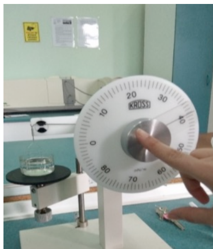
Fig. 4. Krüss K6 tensiometer
